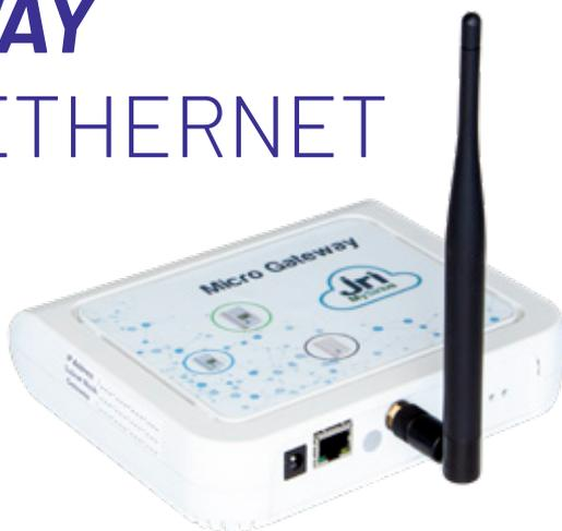
*I Gateway LORA permettono di collegare i data logger Marconi LORA e di inviare in maniera automatica i dati registrati al software MySirius in cloud o in locale tramite interfaccia di rete Ethernet.*
