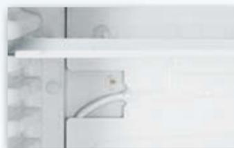
Le apparecchiature da laboratorio sono predisposte per poter integrare una **sonda indipendente** (ad es. sonda NTC o analoghi strumenti di misurazione disponibili in modo opzionale).
