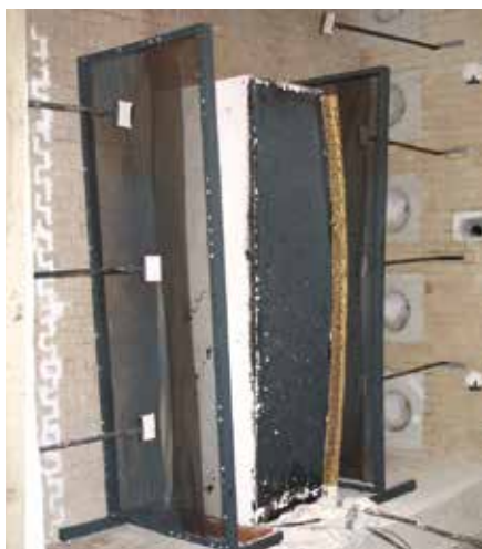
Armadio CHEMISAFE® FIREMY11 DOPO della prova di resistenza al fuoco
