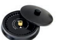
Rotore ad angolo fisso 37° per provette Eppendorf® da 0,5 ml. Con coperchio BIOSAFE  | 15000              | 21.000       | 36              | 40100852 |
